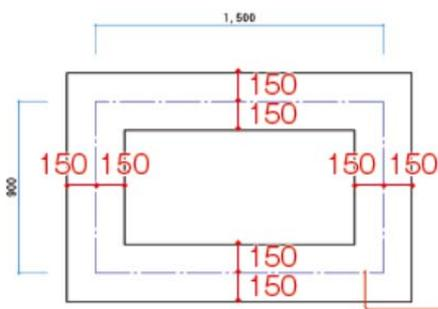
一点鎖線の長方形を「□」コマンド(p.91)で作図する
